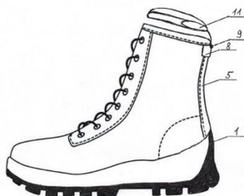
Рис. 10. Общий вид устройства антистатической обуви с заземляющими свойствами: 1 – электропроводный слой подошвы; 5 – задний наружный ремень; 8 – карман; 9 – кнопка; 11 – эластичный браслет, в состав которого входят токопроводящие нити
